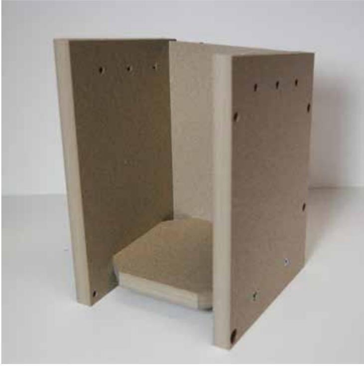
**Étape 8:** Maintenant placer le panneau supérieur (toit) sur le haut du nichoir. Assurez-vous d'avoir les rainures vers le haut. Insérer les 6 vis à travers le panneau supérieur et les visser dans le panneau de gauche, de droite et arrière.
